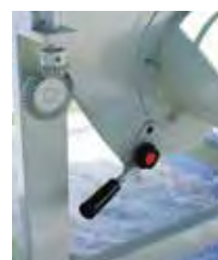
メンテナンスレバーの開閉に より残留物を取り除きます。
