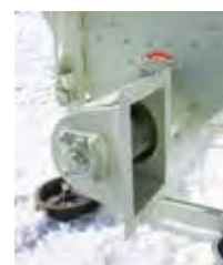
昇降機のサイズに合わせて ジョイント可能。(昇降機の ジョイント部の加工が必要)
