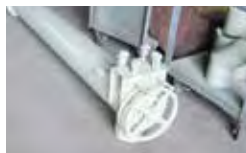
投入、出口のみの 簡易型コンベア
